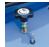
Schnitt Höheneinstellung: wahlweise über die Absenkbegrenzung mit Einstellrad und Anzeige direkt neben dem Sitz, alternativ über die Stützradverstellung.
