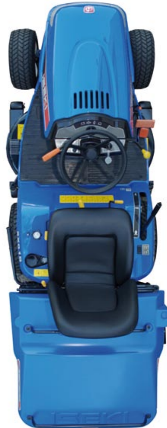
Schnitt Höheneinstellung: wahlweise über die Absenkbegrenzung mit Einstellrad und Anzeige direkt neben dem Sitz, alternativ über die Stützradverstellung.
