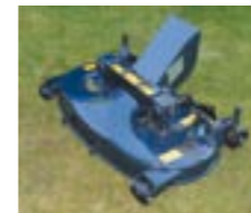
2-Messer-Mähdeck mit Gelenkwellen und Getriebeantrieb. Die Messerbefestigung ist zusätzlich durch einen Scherbolzen gesichert.
