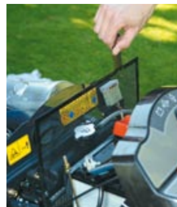
Leichter Wartungszugang, um das Kühlersieb je nach Schmutzanfall schnell reinigen zu können.
