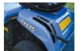
Die Mähwerksaushebung erfolgt per federunterstütztem Handhebel direkt vom Sitz.
