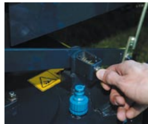
Schnell, mit wenigen Handgriffen lässt sich das Mähwerk, z.B. zu Reinigungsarbeiten, werkzeuglos demontieren. Leichte Verunreinigungen werden über den genormten Wasseranschluß rechts und links am Mähwerk entfernt.
