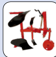
Volldrehpflug mechanisch drehend
