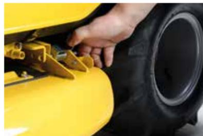
Schnellverschluss zum Abklappen der Mähwerksflügel
