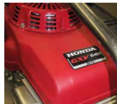
Leistungsstarker Honda-Motor mit 6,6 kW/9 PS Motorleistung (Modell CM 65)
