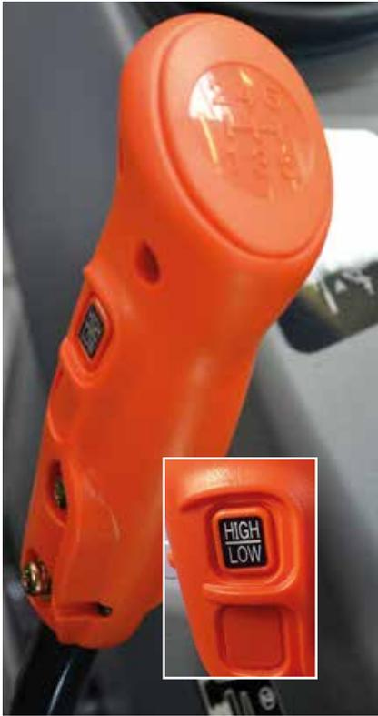
Das Synchron-Getriebe der neuen TJA-Serie verfügt über eine optimale Geschwindigkeitsabstufung im Hauptarbeitsbereich von 0,3 bis 12 km/h. Für schnelle Arbeitseinsätze erzielt der TJA Transportgeschwindigkeiten bis max. 39 km/h (beide Modelle).
