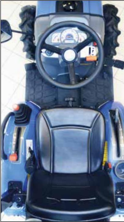
Durch und durch als Profimaschine erkennbar. Der insgesamt hochwertige Auftritt wird durch gummierte Pedale und einen Softgrip-Boden deutlich. Der geräumige Fußraum ermöglicht auch großen Fahrern eine entspannte Fußstellung.
