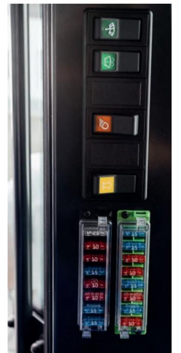
Funktionsschalter und Sicherungsleiste (Schnellzugang)
