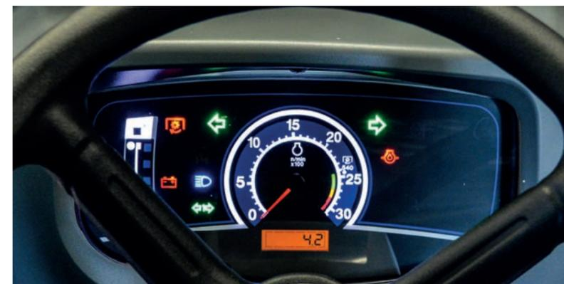
Die übersichtlich aufgebaute Armaturentafel fungiert gleichzeitig als Kommando-Zentrale des Fahrers. Hier wird er mit allen notwendigen Informationen von der aktuellen Drehzahl über die Betriebsstunden bis hin zur Tankanzeige versorgt. Die Instrumententafel ist zudem mit leicht erkennbaren Kontrollleuchten (Symbolen) versehen, die auf den Betriebszustand der Maschine hinweisen.
