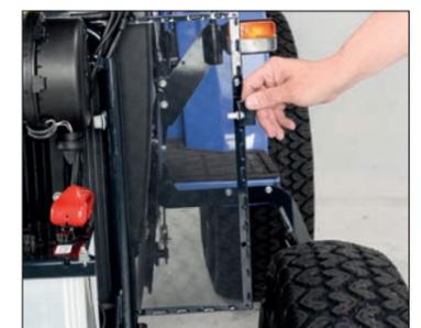
Lüftungsgitter vor Kühler herausziehbar.
