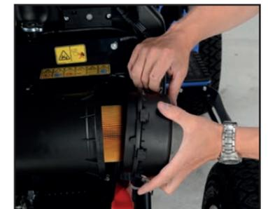
Leichtes Reinigen des Luftfilters möglich
