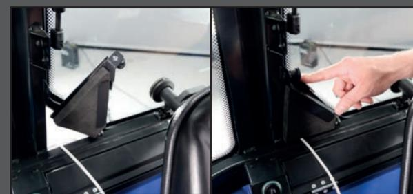
Kabeldurchführung an der Heckscheibe
