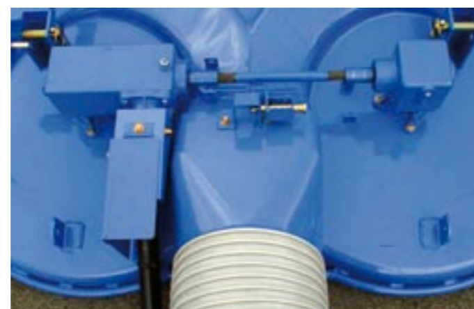
Das Mähwerk und die Winkelgetriebe werden keilriemenfrei über Wellen angetrieben.
