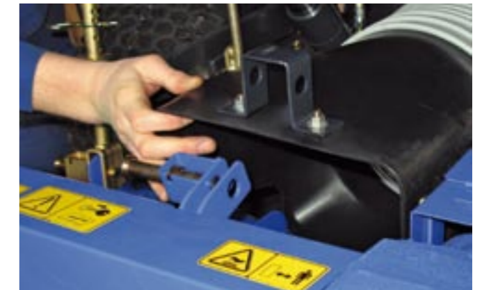
Für Reinigungsarbeiten kann der Saugschuh in Sekunden demontiert werden.
