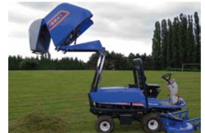
Durch Anheben des Grassammelbehälters ist der Motor für Wartungsarbeiten frei zugänglich.
