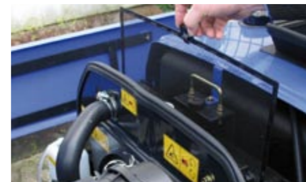
Der Motor saugt die Kühlluft im staubfreien Bereich hinter dem Fahrersitz an. Dadurch wird die Motortemperatur im Einsatz niedrig gehalten.
