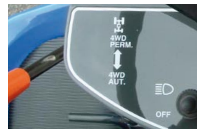
Wählen Sie, ob der Allradantrieb sich automatisch bei schwierigen Geländesituationen zuschaltet oder permanent in Funktion ist.
