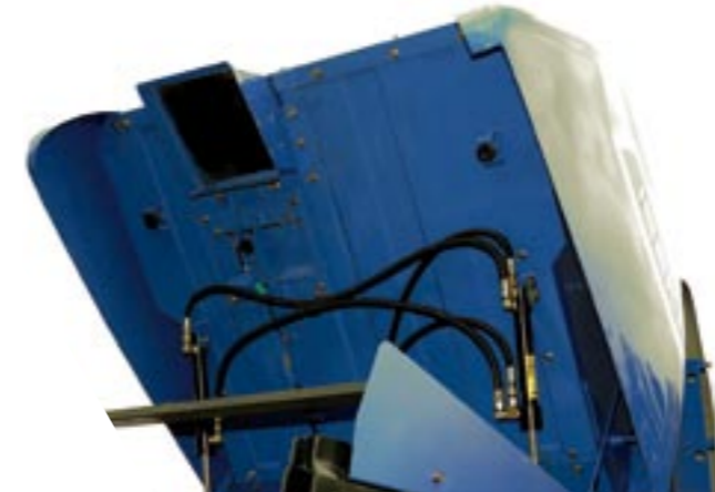
Hydraulikzylinder und -leitungen sind anfahr- geschützt unter dem Behälter angebracht.
