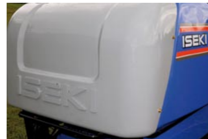
Durch die hintere Abdeckhaube wird die Abluft der Grasaufnahme nach unten zum Boden abgeleitet. So wird der Fahrer vor Flugstaub geschützt.
