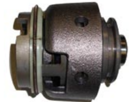
Die Automatik-Allradkupplung schaltet bei Schlupf der Vorderräder automatisch die Hinterräder zu. Im Extremfall kann zusätzlich die Differentialsperre der Vorderachse aktiviert werden.
