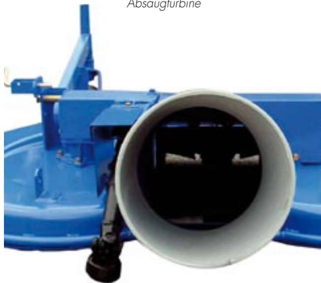
Das Gras wird direkt und ohne Leistungsverlust in die Turbine befördert.
