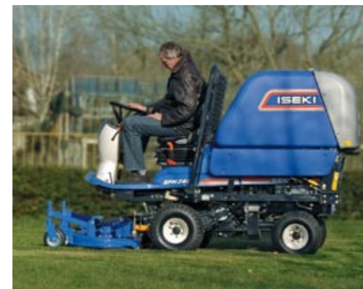
Durch die leistungsfähige Zentralturbine wird der Grassammelbehälter unter Druck befüllt. Dadurch wird eine nahezu 100%ige Befüllung erreicht.
