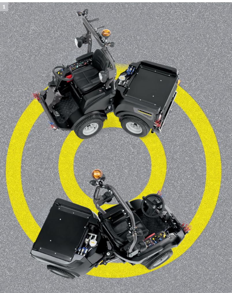
**1** Wendigkeit ist gut. Hohe Wendigkeit ist besser. Extreme Wendigkeit durch Knicklenkung und hundertprozentige Spurtreue ist Kärcher. Weil bei Kärcher Geräteträgern mit Knicklenkung der Hinterwagen zu 100% in der Spur des Vorderwagens läuft. So wird jeder Randstein und jedes Hindernis umfahren ohne anzuecken. Und das macht diese Maschinen so flexibel einsetzbar.
